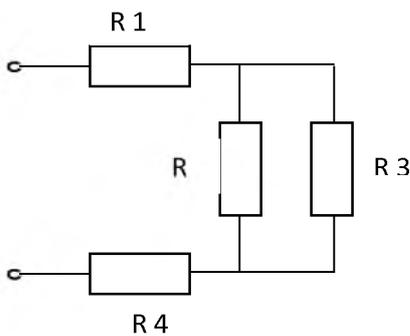
В электрической цепи с сопротивлениями  $R_1=14$  Ом,  $R_2=20$  Ом,  $R_3=80$  Ом,  $R_4=10$  Ом напряжение питания  $U=120$  В. Определить эквивалентное сопротивление  $R$ , силу тока  $I$  и общую мощность всей цепи  $P$ . Определить силу тока  $I_i$  и падение напряжения  $U_i$  на каждом резисторе, а также мощность  $P_i$  каждого резистора и мощность  $P$  всей цепи.
