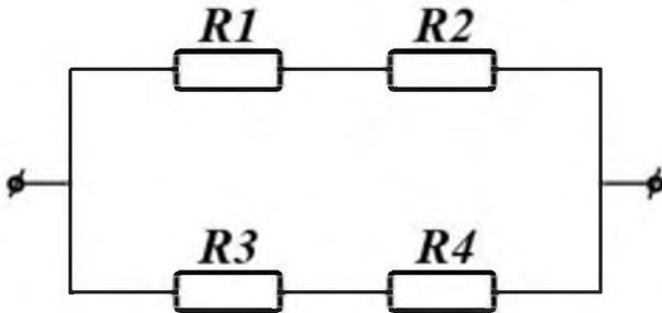
В электрической цепи с сопротивлениями  $R_1=8$  Ом,  $R_2=12$  Ом,  $R_3=24$  Ом,  $R_4=6$  Ом напряжение питания  $U=60$  В. Определить эквивалентное сопротивление  $R$ , общий ток  $I$  и мощность всей цепи  $P$ . Определить ток и напряжение каждого участка  $I_i$ ,  $U_i$ .
