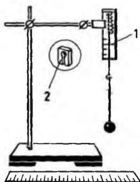
Для выполнения работы собирают установку, показанную на рисунке. Динамометр укрепляется в лапке штатива. Фиксатором 1 показаний динамометра служит пластинка из пробки размером 5 x 7 x 1,5 мм. На рисунке фиксатор в увеличенном масштабе помечен цифрой 2. Пластинку из пробки надрезают ножом до середины и насаживают на проволочный стержень динамометра. Фиксатор должен перемещаться вдоль стержня с малым
