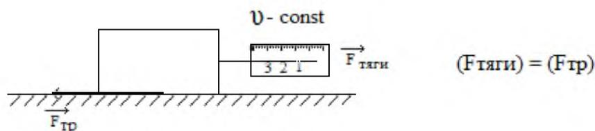
Измеряя силу, с которой динамометр действует на брусок ( $F$  тяги), мы определяем силу трения.
