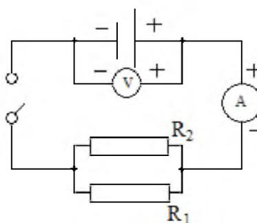
2. Начертите схему и соберите цепь, при этом цепь не разбирайте, а только от - амперметра отключите один провод и подключите его к + источника тока.
