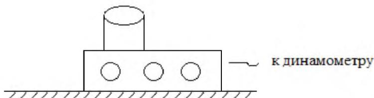
Измерьте силу трения и вес бруска с грузом
